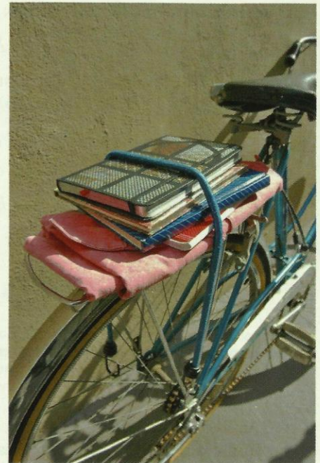
Doc. 6 Le sandow permet de fixer les objets sur le porte-bagages. Déformé, il possède de l'énergie potentielle élastique : il faut être prudent lorsqu'on le manipule.
